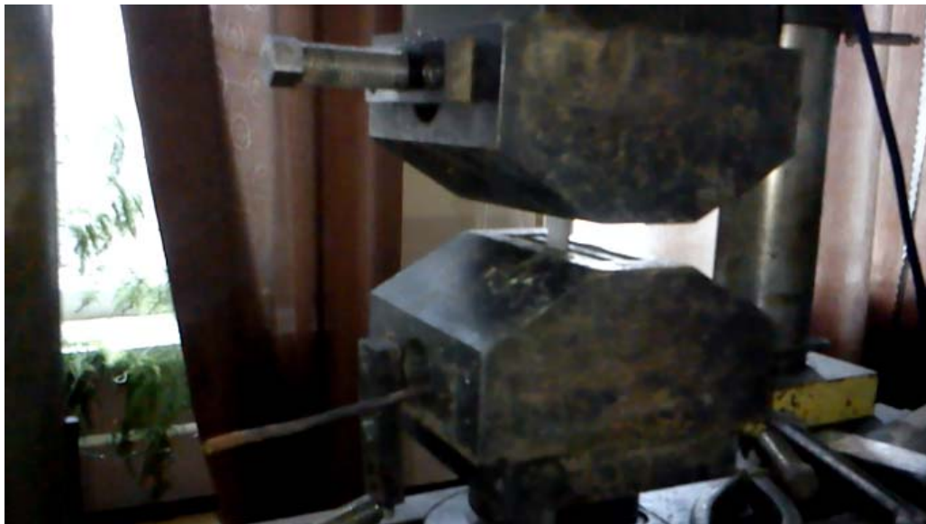
Рис. 3. Зразок, закріплений у затискачах для плоских заготовок універсальної машини УМЕ-10ТМ
